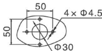
Габаритные и установочные размеры разъединителей ВР-101 125-1600А ЗР(4Р) тип S(WS)
