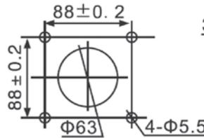
Установочные размеры гнезда ручки на дверь шкафа типа В
