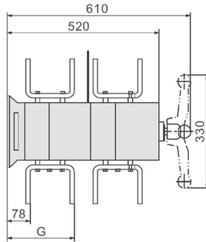
Установочные размеры гнезда ручки на дверь шкафа
