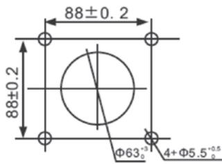
Установочные размеры гнезда ручки на дверь шкафа, Тип В
