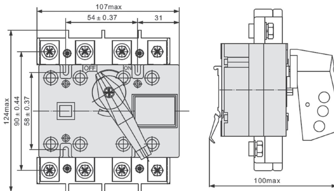
Габаритные и установочные размеры выключателей-разъединителей ВР-101 (W) 40-100А, ЗР(4Р)
