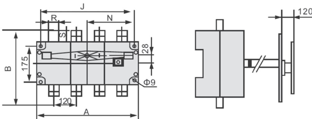
Установочные размеры гнезда ручки на дверь шкафа
