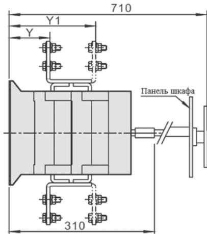
Установочные размеры гнезда ручки на дверь шкафа
